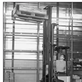
Mástil de gran visibilidad y posición diagonal del conductor mejoran visibilidad y confort.
