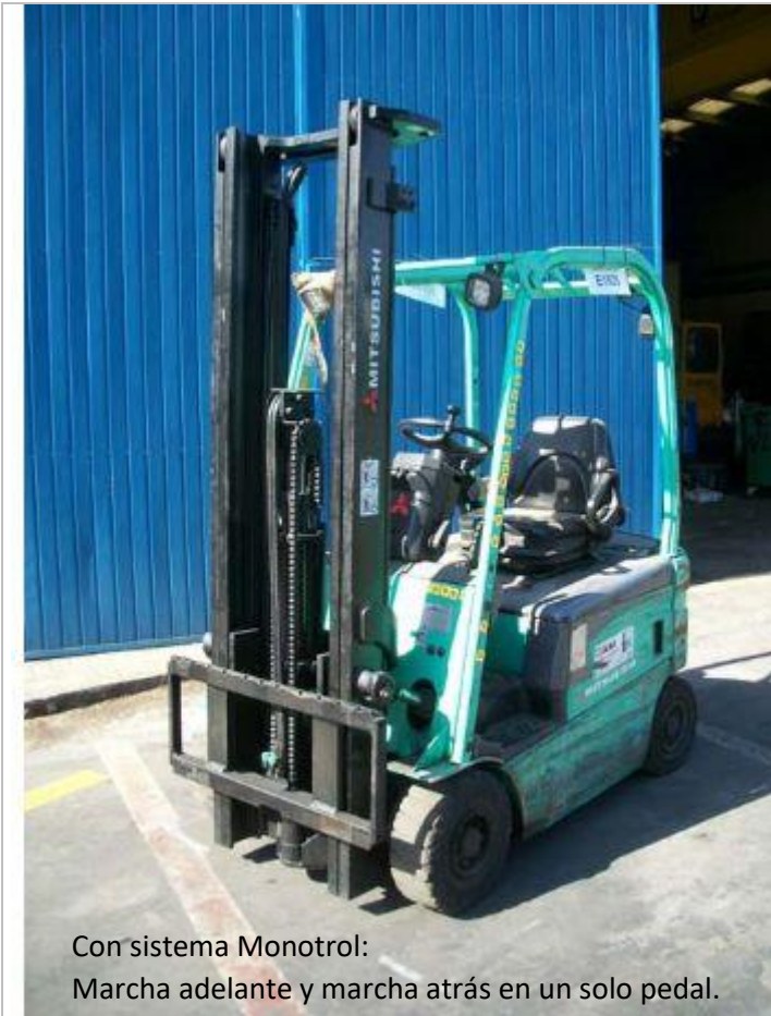
Con sistema Monotrol: Marcha adelante y marcha atrás en un solo pedal.
