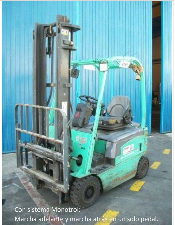
Con sistema Monotrol: Marcha adelante y marcha atrás en un solo pedal.
