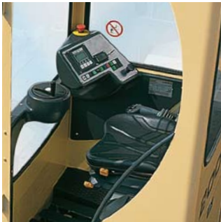
Cabina estándar Q850 (L=930 mm. x B=850 mm.) con dirección electrónica
