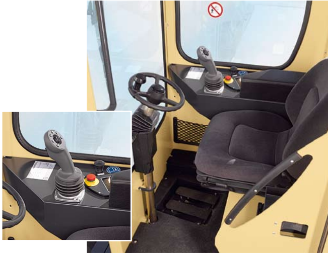
Cabina confort especial Q900 (L=930 mm. x B=900 mm.) con dirección hidráulica y volante regulable
